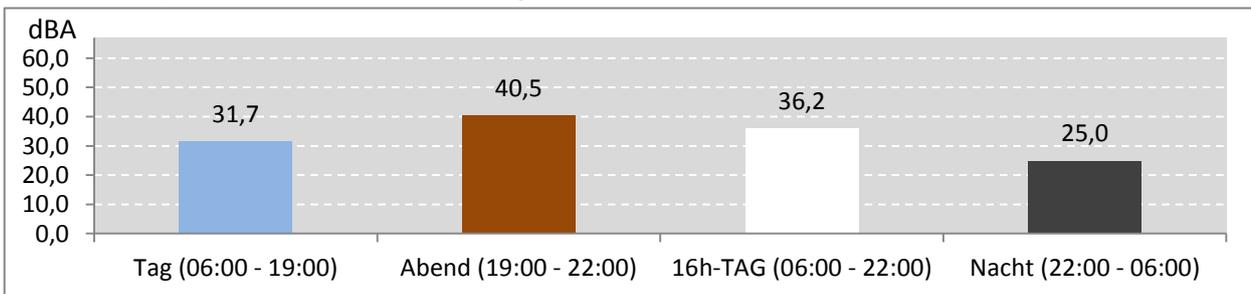
Abb. 9: LEQ bei Pistenbetriebsrichtung "östliche Winde" 67 Stunden im Messzeitraum
